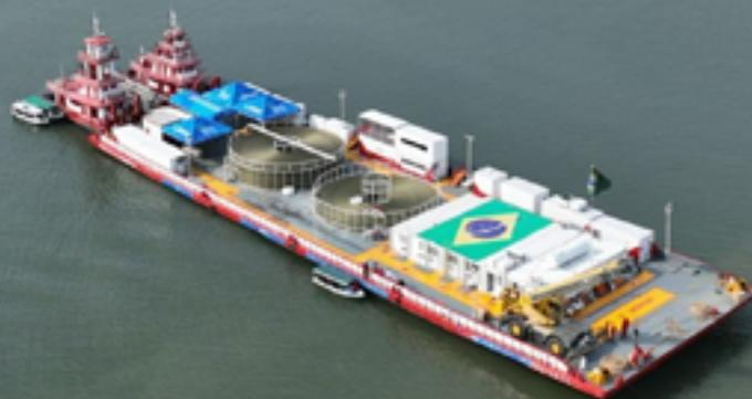
**Figura 3.** Balsa de instalação do cabo da Infovia 01.
