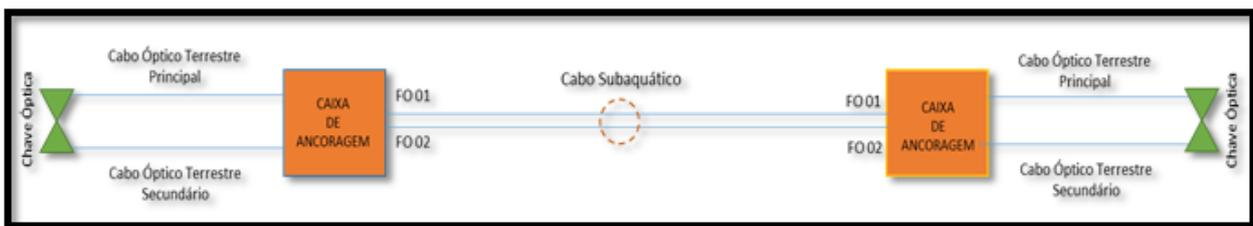
Figura 7. Diagrama de utilização de chave óptica
